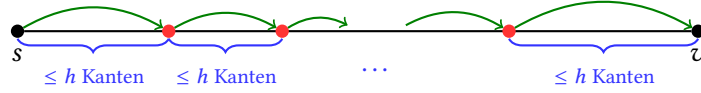
Abbildung 6.5: Unterteilung des kürzesten Wegs von s nach v so dass jeweils nach höchstens h Kanten ein Zentrum (rot) erreicht wird.
